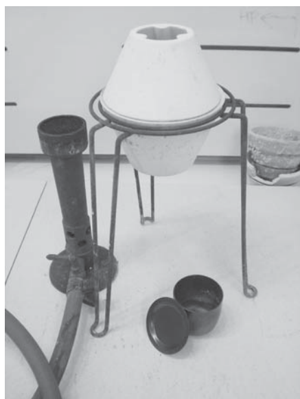
上 蛍光X線EDX 液体窒素で冷やします 中 FTIR 下 マッフル炉とバーナー ジルコニウム製のつぼ（白金族の分析に 白金製のつぼは使えない）
